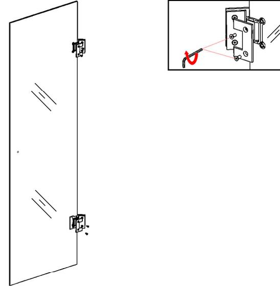
Lösen Sie die Schrauben am Scharnier und positionieren Sie es am Glas. Zwischen Glas und Scharnier muss jeweils eine Gummieinlage platziert werden.
