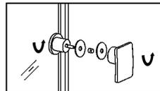
Drehen Sie den Griff auf. Schieben Sie auf die Schraube eine Unterlegscheibe und stecken Sie die Schraube durch das Loch im Glas. Unterlegscheibe drauf und Griff drauf drehen.
