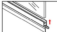
Drücken Sie die Dichtung an der Unterkante der Tür auf.
