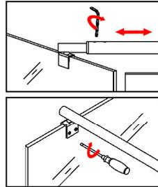
Setzen Sie den Stabilisator auf das Glas auf und richten diesen aus. Ziehen Sie anschließend auf beiden Seiten die Schrauben an der Oberkante fest.
