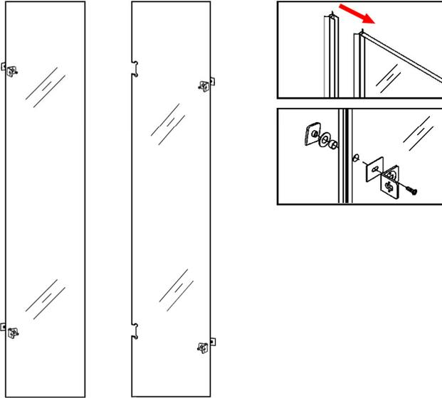
Schieben Sie die Dichtung an der Hinterkante der Seitenelemente auf.
