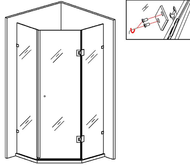
Setzen Sie die Schiere am Seitenelement ein. Achten Sie darauf, dass sich auf jeder Seite eine Gummieinlage befindet. Abdeckung drauf und festschrauben.
